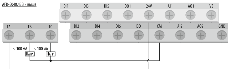
Рисунок 36 – схема подключения нагрузки к релейному выходу (питание от внутреннего источника питания 24 В).
