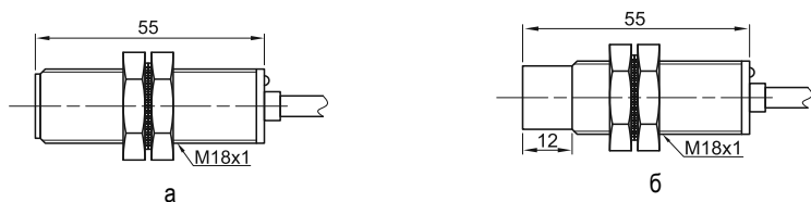
Рисунок 8 – Габаритные и установочные размеры датчиков LA18 а – утапливаемое исполнение, б – неутапливаемое исполнение
