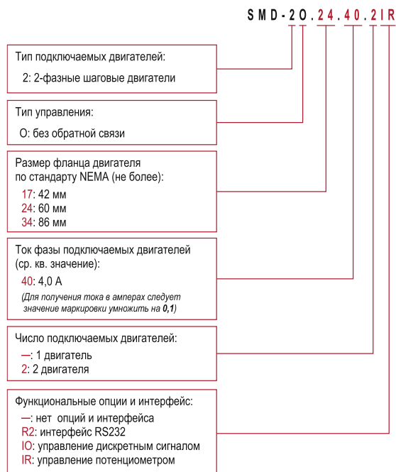
Рисунок 2 - расшифровка условного обозначения драйверов
